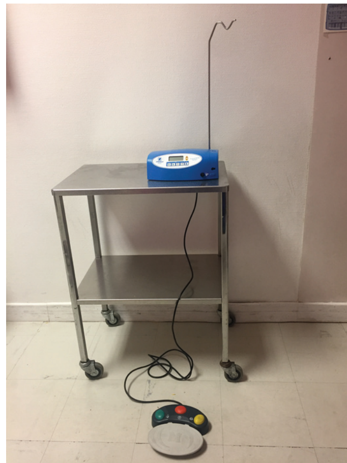
Figure 4. Moteur d'implantologie et chariot porte-moteur. Le moteur est muni d'une potence et d'une pédale pour une commande au pied.
